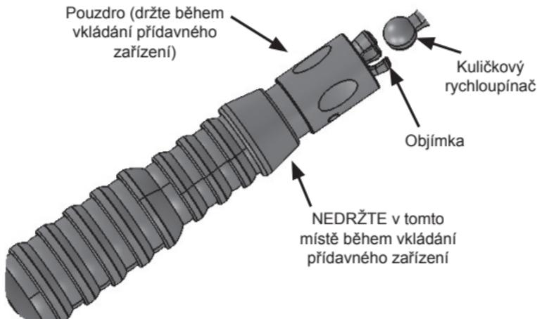
Obr. 3 – Připojení stabilizačního přídavného zařízení Titan™ 360 k ramenu stabilizátoru s kuličkou
