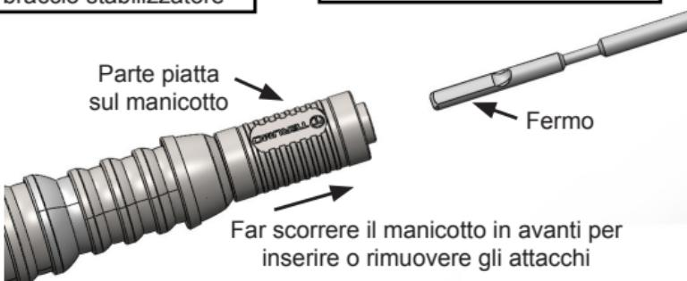
**Figura 2 – Fissaggio dell'attacco stabilizzatore Titan™ al braccio stabilizzatore**
