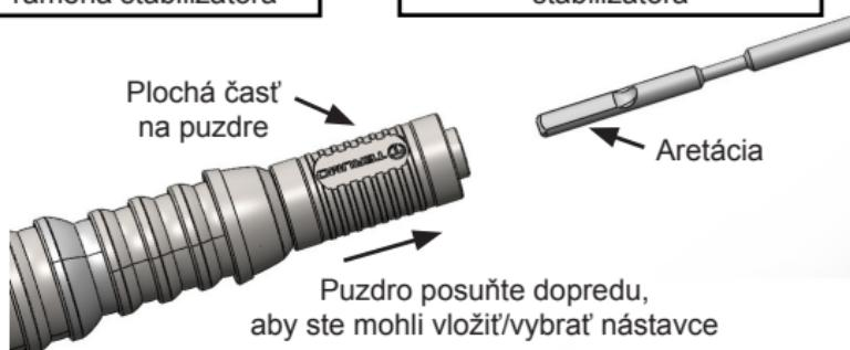
Obrázok 2 – pripojenie nástavca stabilizátora Titan™ k ramenu stabilizátora
