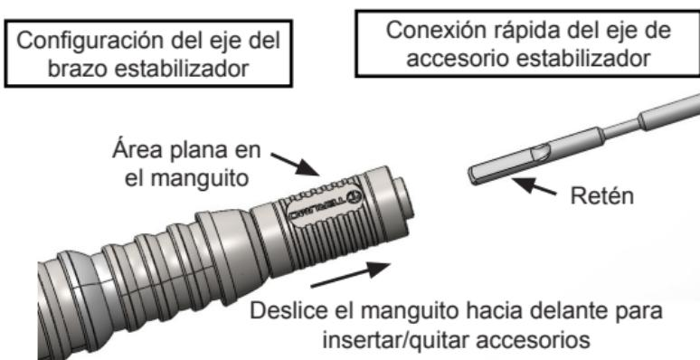
**Figura 2 – Acoplamiento del accesorio estabilizador Titan™ al brazo estabilizador**
