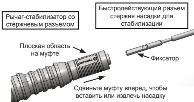
**Рисунок 2 – Присоединение насадки для стабилизации Titan™ к рычагу-стабилизатору**
