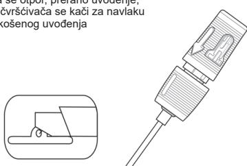
**NAPOMENA:** Nemojte nastavljati sa postupkom dok se ne uverite da je učvršćivač ispravno uveden (Slika 9). Ukoliko učvršćivač nije ispravno uveden, uređaj Anglo-Seal neće raditi.
