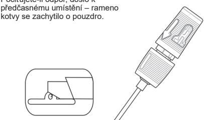
**POZNÁMKA:** Nepokračujte, dokud se nepřesvědčíte o správném umístění kotvy (obr. 9). Při nesprávném umístění kotvy nebude zařízení Anglo-Seal fungovat.
