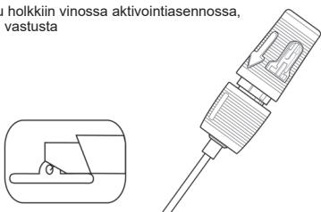
**HUOMAUTUS:** Toimenpidettä ei saa jatkaa ennen kuin ankkuri on asennettu oikein (kuva 9). Jos ankkuri on asennettu väärin, Angio-Seal-laitte ei toimi.
