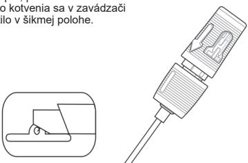
**POZNÁMKA:** Nepokračujte, kým si nie ste istí, že sa kotvenie zaviedlo správne (obrázok 9). Ak je kotvenie zavedené nesprávne, systém Anglo-Seal nebude fungovať.
