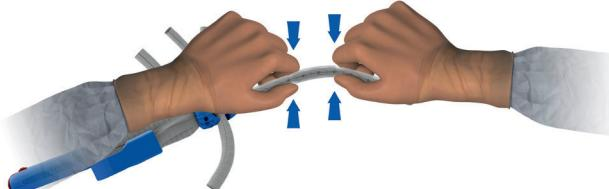
**Figura 7 – Rimozione di schiaccature nella guaina**
